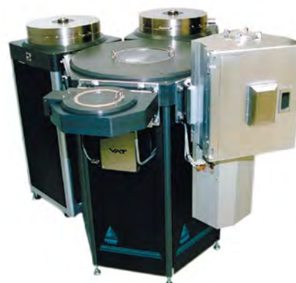
На фото показан Oracle III с 1 вакуумным элеватором для кассет и 2-мя процессными модулями
